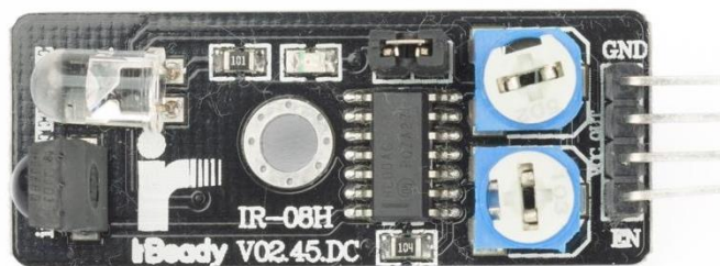
Slika 5 - Infrardeči senzor za zaznavanje ovir ali črne črte.
