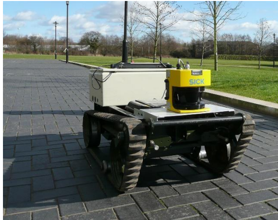
Slika 7 - Mobilni roboti so opremljeni s senzorjem LIDAR, ki jim omogoča kartiranje okolice in izogibanje oviram [8].
