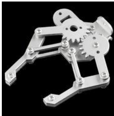
Slika 3. Krajni efektor robota [7].
