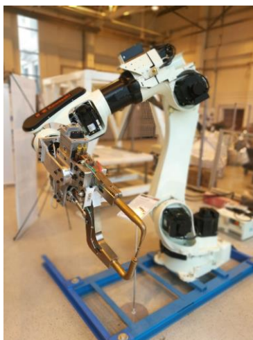
Slika 1. Robot za točkasto zavarivanje [4].
