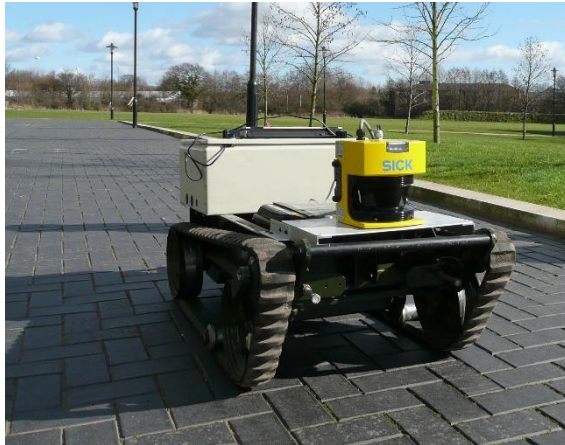
Slika 7. Mobilni roboti opremljeni su s LIDAR senzorom, koji im omogućuje mapiranje okoline i izbjegavanje prepreka [8].
