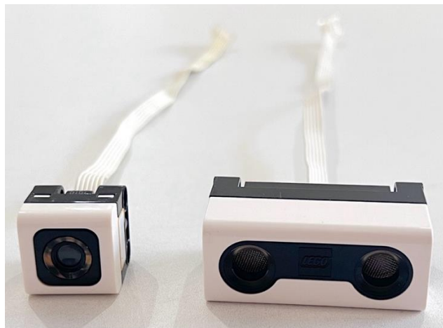
Slika 6. Senzor boje i ultrazvučni senzor za Lego Spike Prime robote.
